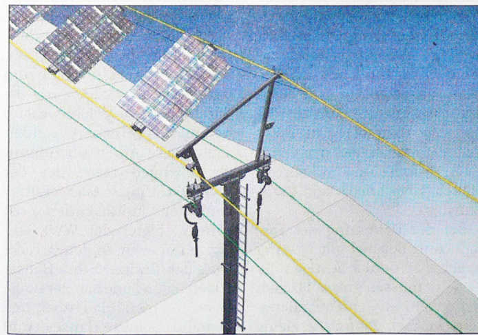
Das Solar Wings System: Auf Seilen befestigte Solarmodule können über Skilifte oder Lawinerverbauungen montiert werden.
