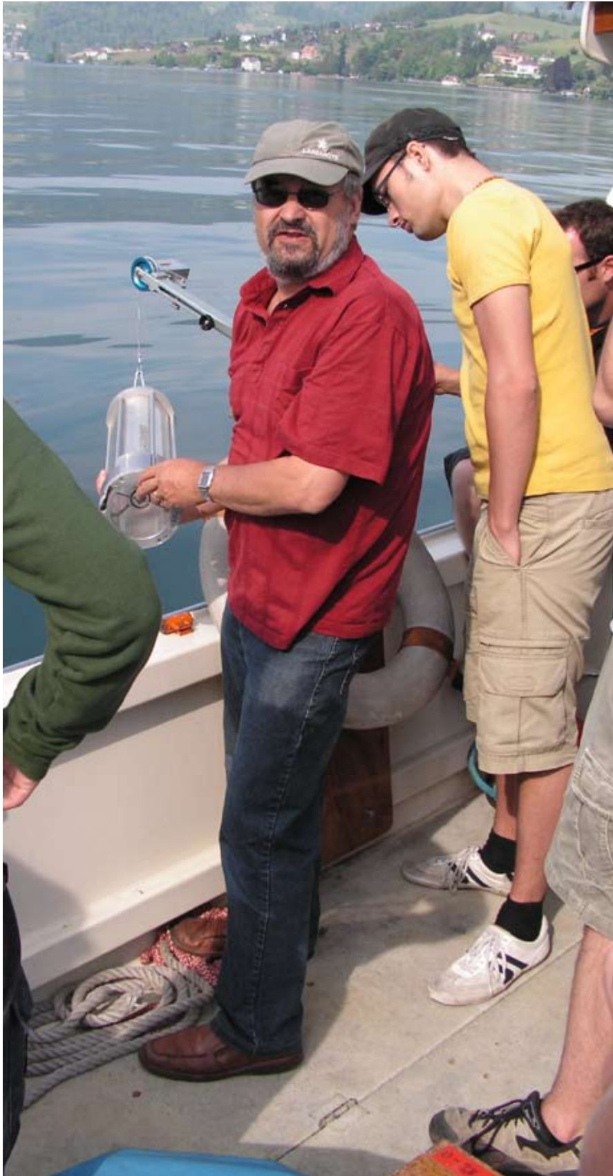
Dr. Bossard erklärt ein Gerät, mit dem bis in eine Tiefe von 25 Metern gleichmässig Wasser entnommen werden kann.
