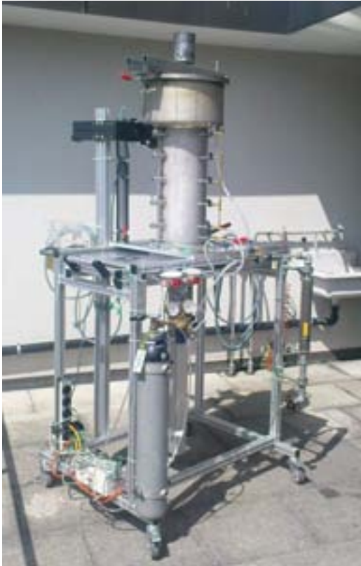
Abbildung 1: Experimental-Holzvergaser auf dem Dach des Maschinenlabors
