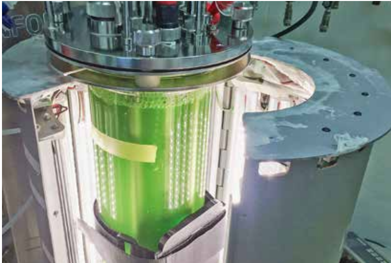
Die Mikroalgen werden in einem speziellen Bioreaktor mit Beleuchtungssystem kultiviert.
