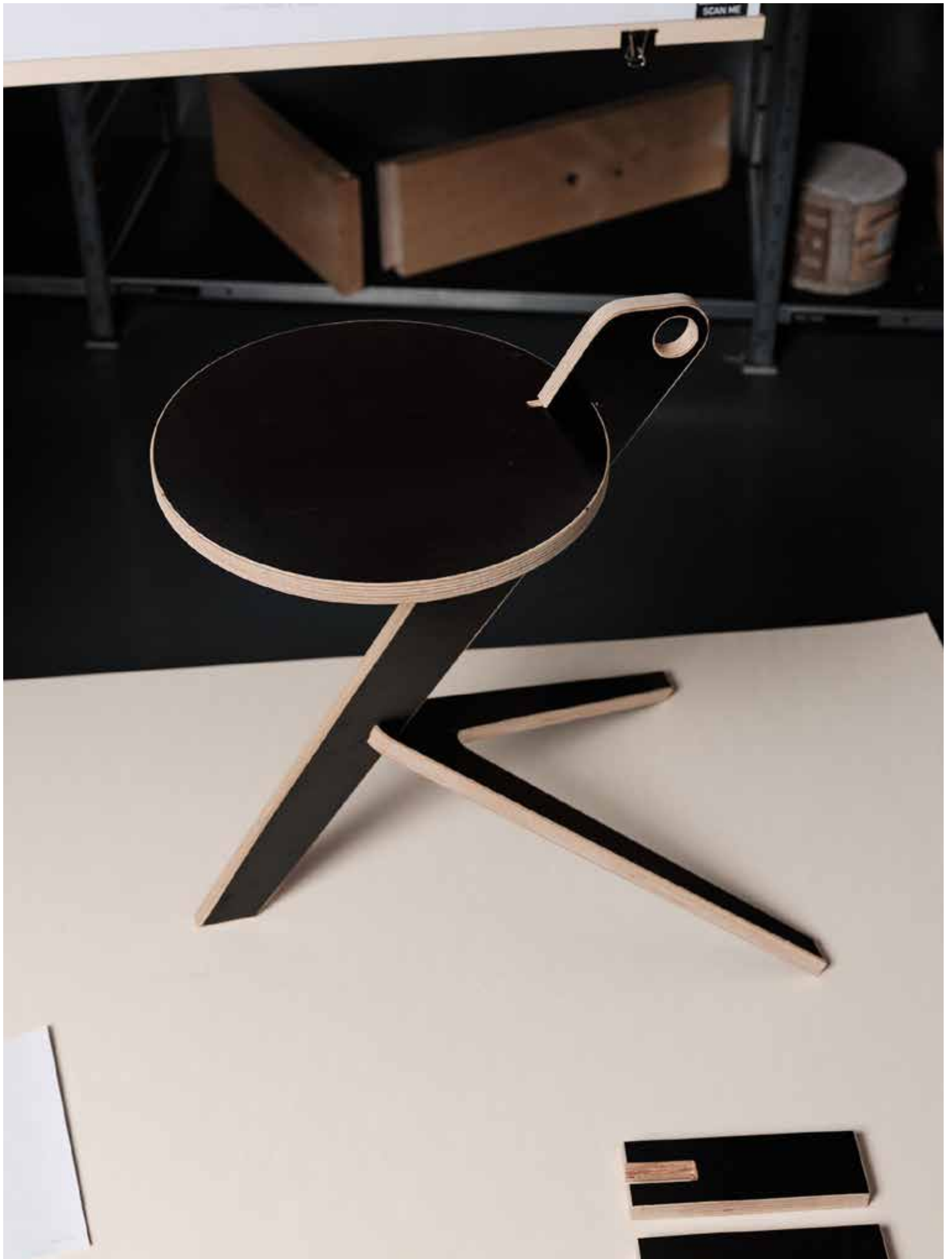
Beistelltisch Accanto wurde von Architekturstudierenden aus Restholz gefertigt und ist dank einer Steckverbindung demontierbar.
