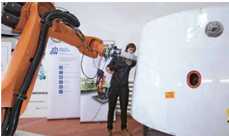
Der Benutzer bringt den Roboterarm mit der aufgesetzten Sandstrahldüse manuell in die Ausgangsposition.
