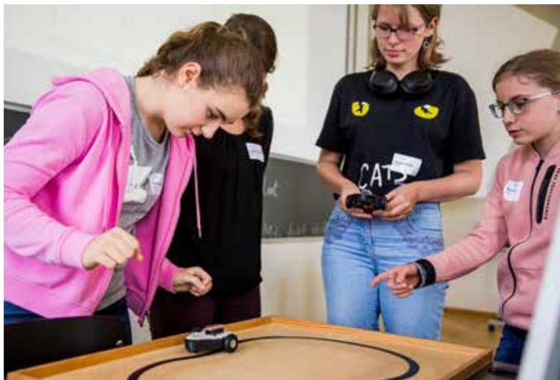
Der mobile Roboter soll einer Linie folgen. An der Teststrecke zeigt sich, ob die Befehle richtig programmiert sind oder noch optimiert werden müssen.
