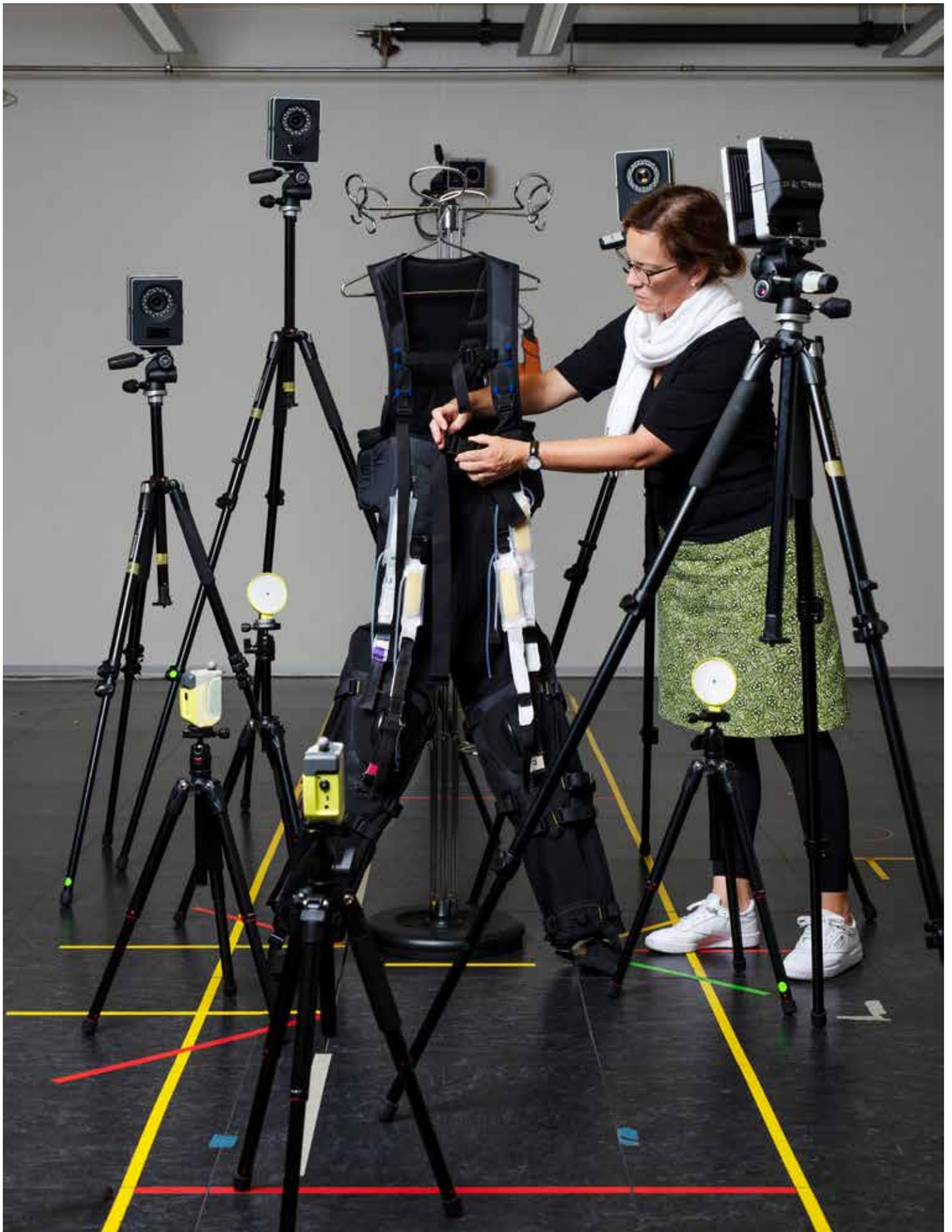
Die intelligenten Leggings unterstützen Menschen mit eingeschränkter Mobilität: XoSoft, der Prototyp eines modularen Soft-Exoskeletts, das ZHAW-Forschende mit europäischen Partnern entwickelt haben, versteift sich und wird weich, je nach Bewegung.
