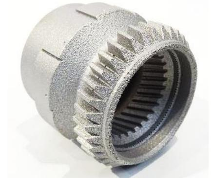
*Optimierter Kupplungsstern additiv gefertigt (SLM)*
