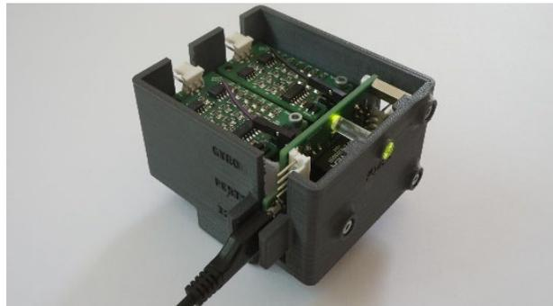
Sensorbox mit EMG-Sensoren und DC/DC-Board.
