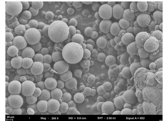
REM-Aufnahme: Mikrokapseln in einem funktionalen Lack eingebunden
