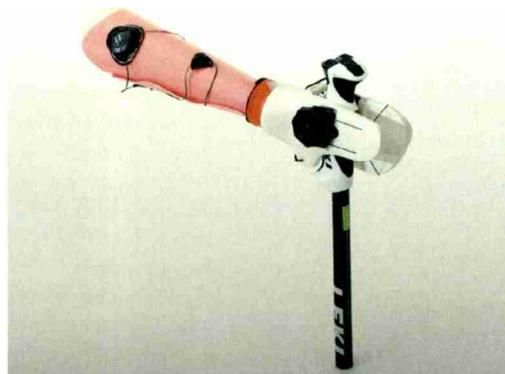
Universalhandprothese (links) und Handprothese zum Skilaufen (rechts) aus dem 3D-Drucker (Fotos: ZHAW)
