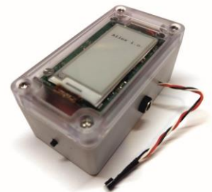
Das Werkzeugbuch mit dem Benutzertaster (links), dem E-Paper und dem Temperatursensor (unten) sowie einem Anschluss für den thermoelektrischen Generator (rechts).
