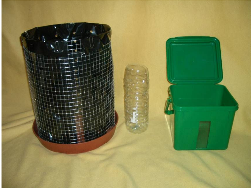
Abbildung 1: Verwendete Kompostbehälter. Von links nach rechts: 6L „Mini-Kompost“, 1,5L PET-Flasche, 3 Liter Kompost-Kübel (Weithalsflasche fehlt).
