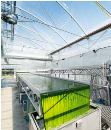
Algenbioreaktor-Anlage im Campus Grüental ZHAW, Foto: Frank Brüderli
