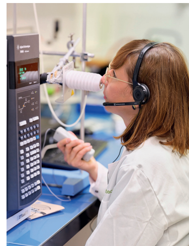
Aromaforscherin Irene Chetschik analysiert den Geruch von Schokolade via Gaschromatographie-Olfaktometrie. Foto: Conradin Frei
