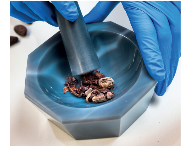
Aufarbeitung von Kakaobohnen für die Gaschromatographie-Olfaktometrie an der Zürcher Hochschule für Angewandte Wissenschaften: Die Bohnen werden in flüssigem Stickstoff tiefgefroren und mit dem Mörser vermahlen. Das Pulver wird anschließend mit frisch destilliertem Diethylether extrahiert. Foto: Brüderli Longhini
