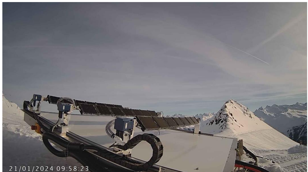
Abbildung 17: Alpine Modell Photovoltaikanlage im Massstab 1:12. Drei Modulreihen mit je sieben Modulen sind auf einer Platte montiert, welche einen variablen Neigungswinkel (Hangneigung) aufweist. Die Modulneigung- und Hangneigung sowie der Reihenabstand zwischen den Modulen können in kurzen Zeitabständen automatisiert verändert werden. Die Kennlinien diverser Module werden laufend gemessen. Damit können verschiedene Anlagenkonfigurationen am selben Standort verglichen werden.
