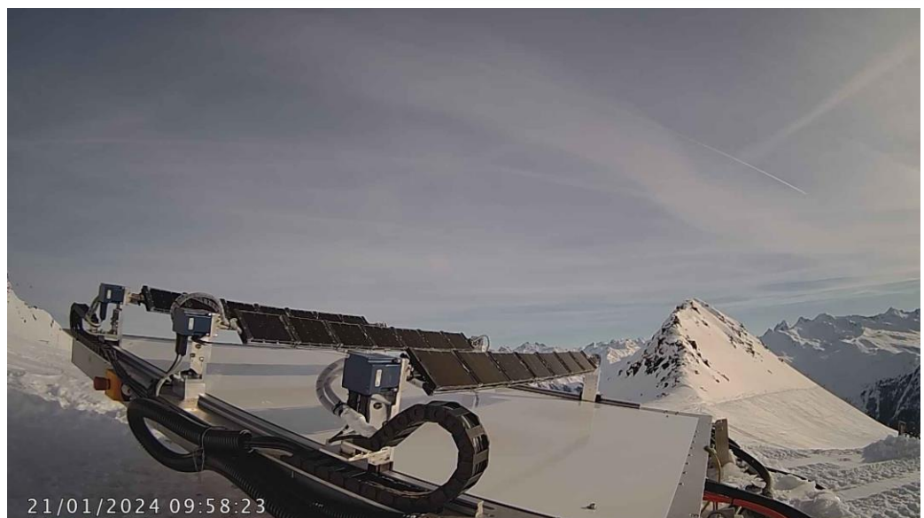
Abbildung 20: Alpine Modell Photovoltaikanlage im Massstab 1:12. Drei Modulreihen mit je sieben Modulen sind auf einer Platte montiert, welche einen variablen Neigungswinkel (Hangneigung) aufweist. Die Modulneigung- und Hangneigung sowie der Reihenabstand zwischen den Modulen können in kurzen Zeitabständen automatisiert verändert werden. Die Kennlinien diverser Module werden laufend gemessen. Damit können verschiedene Anlagenkonfigurationen am selben Standort verglichen werden.
