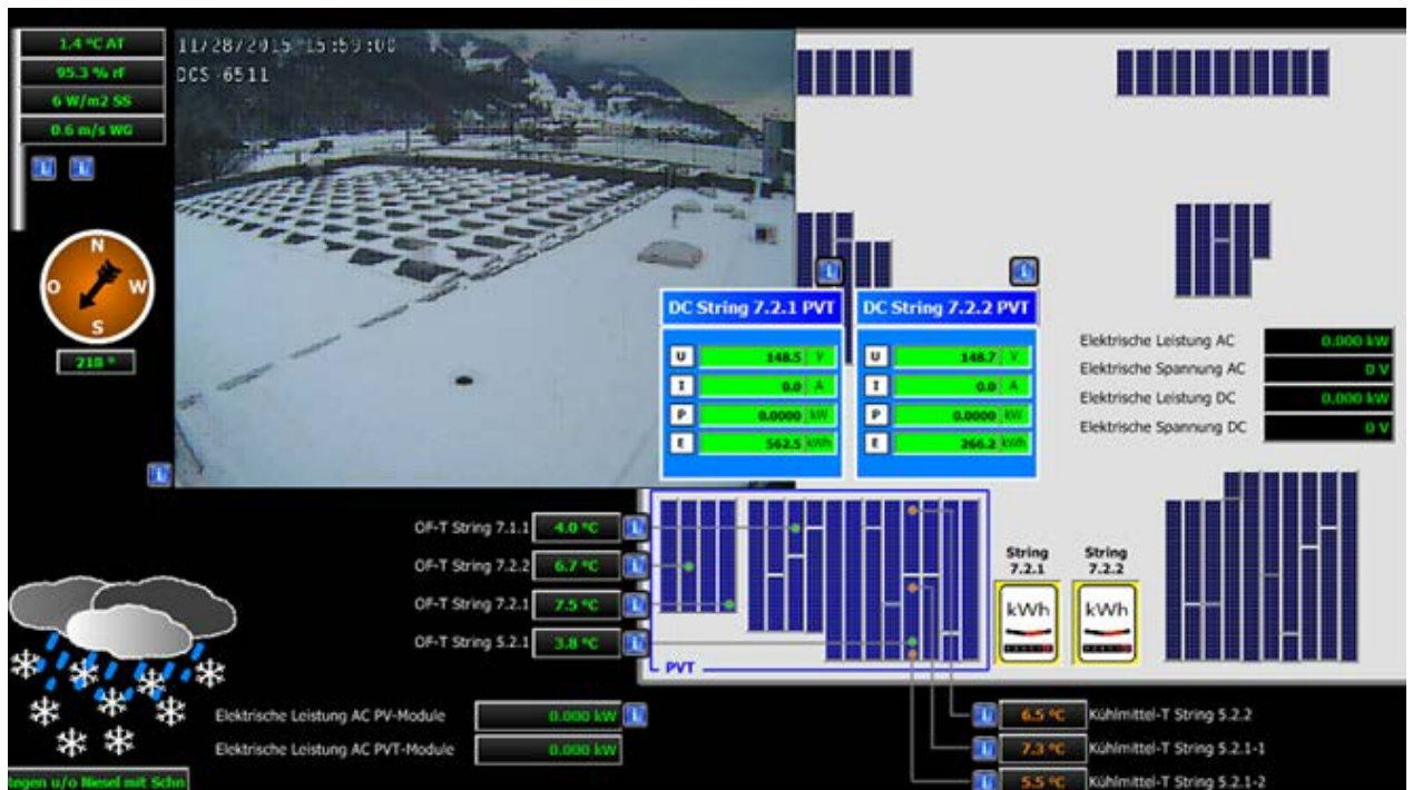
Abbildung 12: Nach ca. 6 Stunden ist der Schnee von den PVT-Modulen abgerutscht, staut sich aber unten an den Modulen
