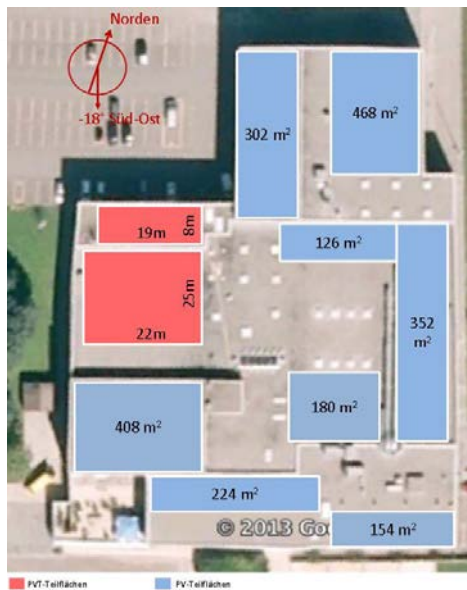
Abbildung 2: Aufteilung der Dachfläche für PVT-Module in roter Farbe und PV-Module in blau (Google Maps, 2013, bearbeitet)
