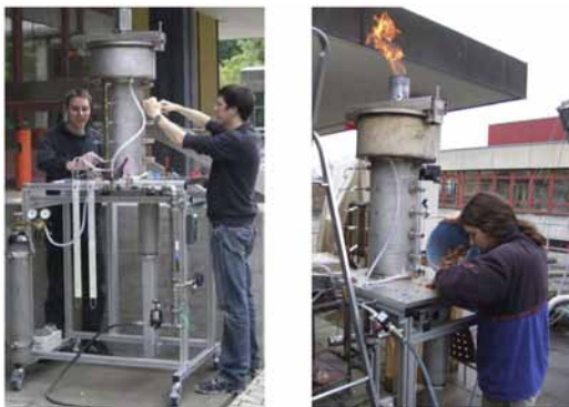
Fig. 1: ZHAW Experimentalvergaser im Aufbau und im Betrieb auf dem Dach des Maschinenlaboratoriums.
